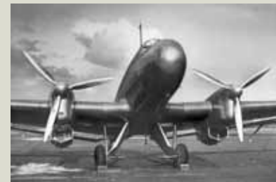
Die Ju 86 war das erste Verkehrsflugzeug mit Dieselmotoren.
