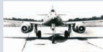
Die Messerschmitt Me 262, der erste Düsenjäger der Welt, wurde von zwei Jumo 004 angetrieben.
