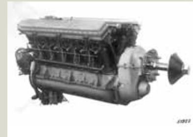
Der Zylinder-V-Motor Junkers L 55 von 1927 war mit bis zu 800 PS der stärkste deutsche Flugmotor.
